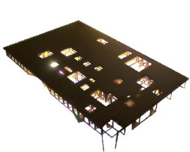
Elemento de cubierta Realizado mediante costillas navales con geometría compleja. La entrada de luz siempre cenital
